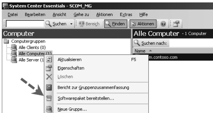
Abbildg. 18.38 Über das Kontextmenü der Computer können auch die erstellten Softwarepakete zugewiesen werden
