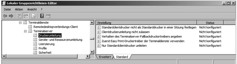
Abbildg. 12.20 Die Umleitung von Druckern kann ebenfalls über Gruppenrichtlinien gesteuert werden
